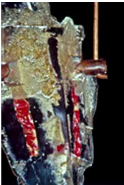
снимка 2. предварително обгорено медно фолио между два слоя излято стъкло; медна тръба, частично вмъкната в стъкломасата*
