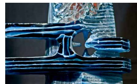
снимки 12 и 13. калаен цъфтеж на синьо флоатно стъкло
