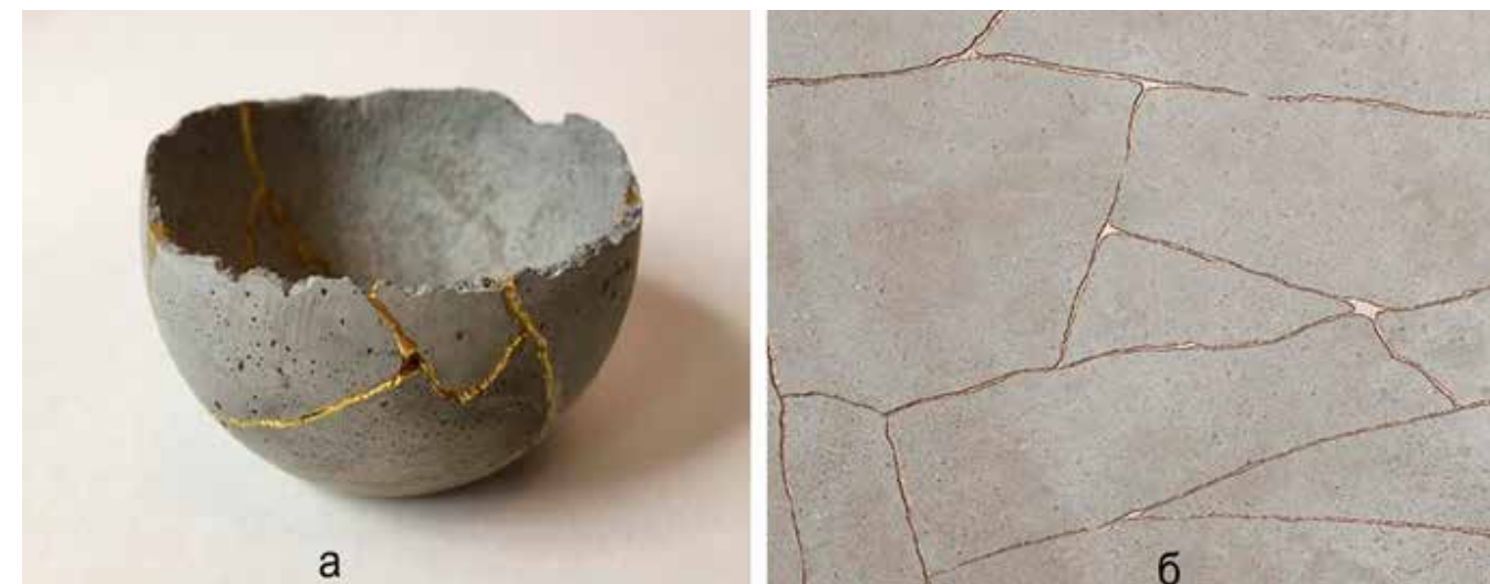
Фиг. 2 Прилагане на техниката Кинцуги при бетонни изделия а – традиционен метод, б – само с повърхностно създадени ивици, имитиращи счупвания
